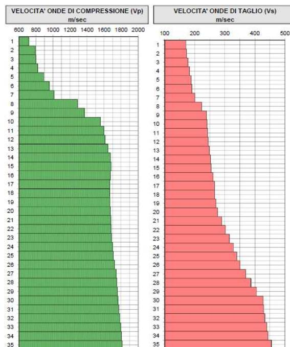
Figura 18 – Profili di velocità delle onde "P" ed "S" ricavati dall'indagine Down-hole eseguita nel foro di sondaggio per questo studio.
