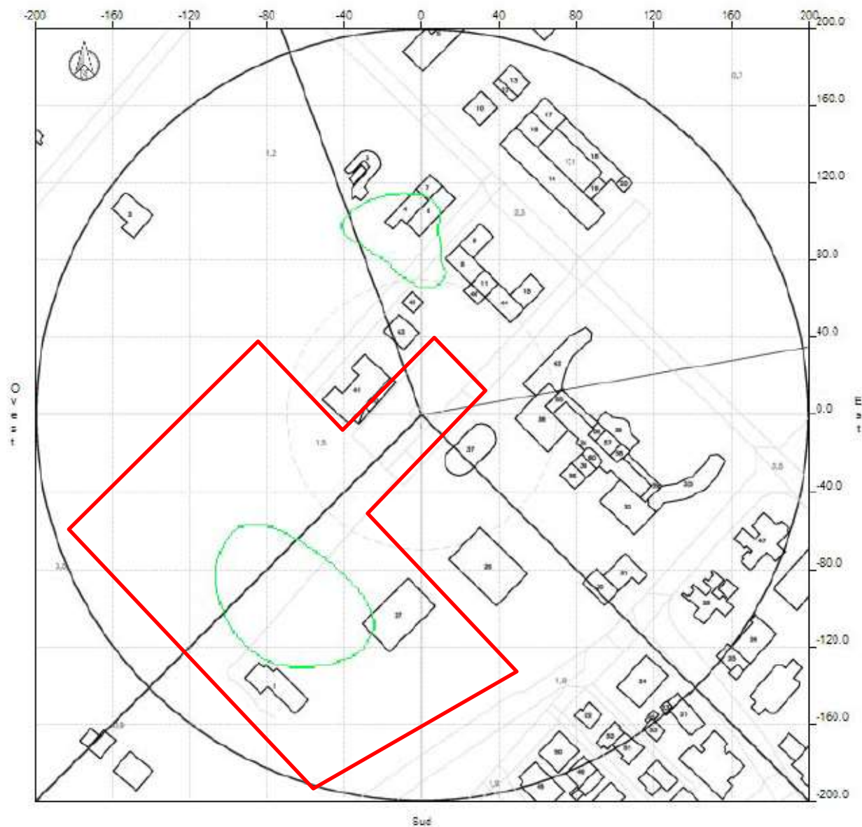
Fig. 2.2.b - Proiezione sul piano orizzontale del volume di rispetto relativo a 6 V/m alla quota di 13.3 m dal piede del supporto ILIAD con sovrapposta in rosso l'area di interesse
