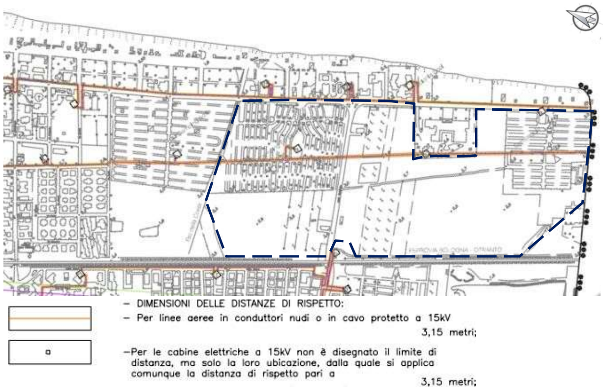
Fig. 2.2.4.a – estratto dalla tavola D.7.6.1. allegata al quadro conoscitivo del PSC con indicate le linee elettriche e le cabine elettriche che interessano l'area di intervento
