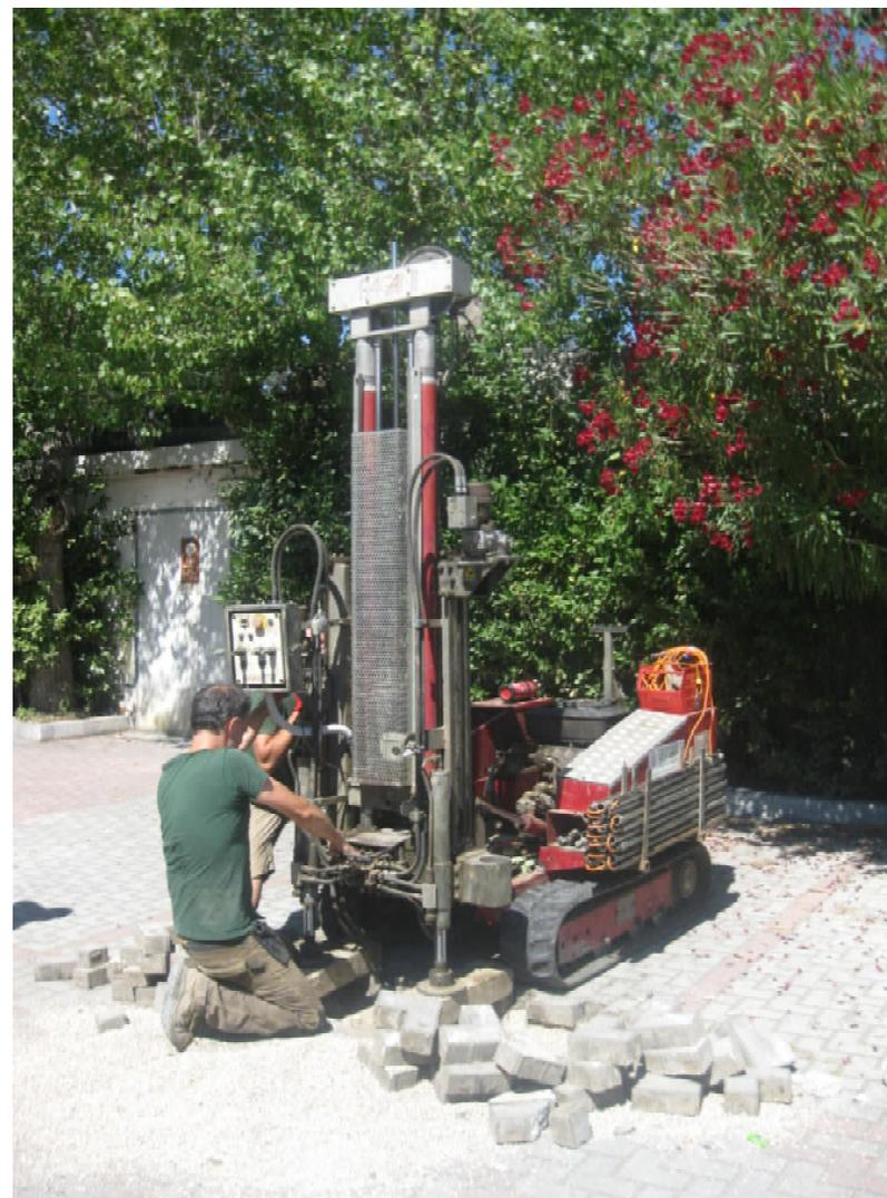
*Figura 4: Esecuzione della prova penetrometrica statica P2*
