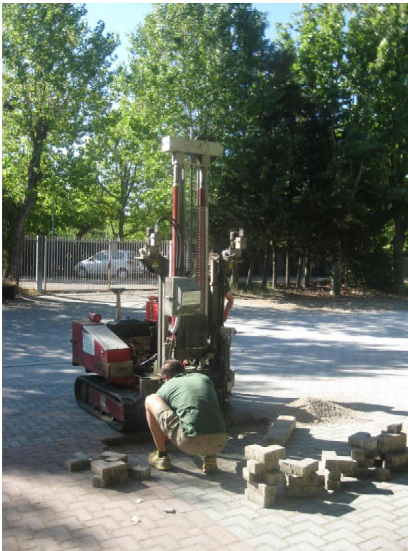
*Figura 3: Esecuzione della prova penetrometrica dinamica P1*
