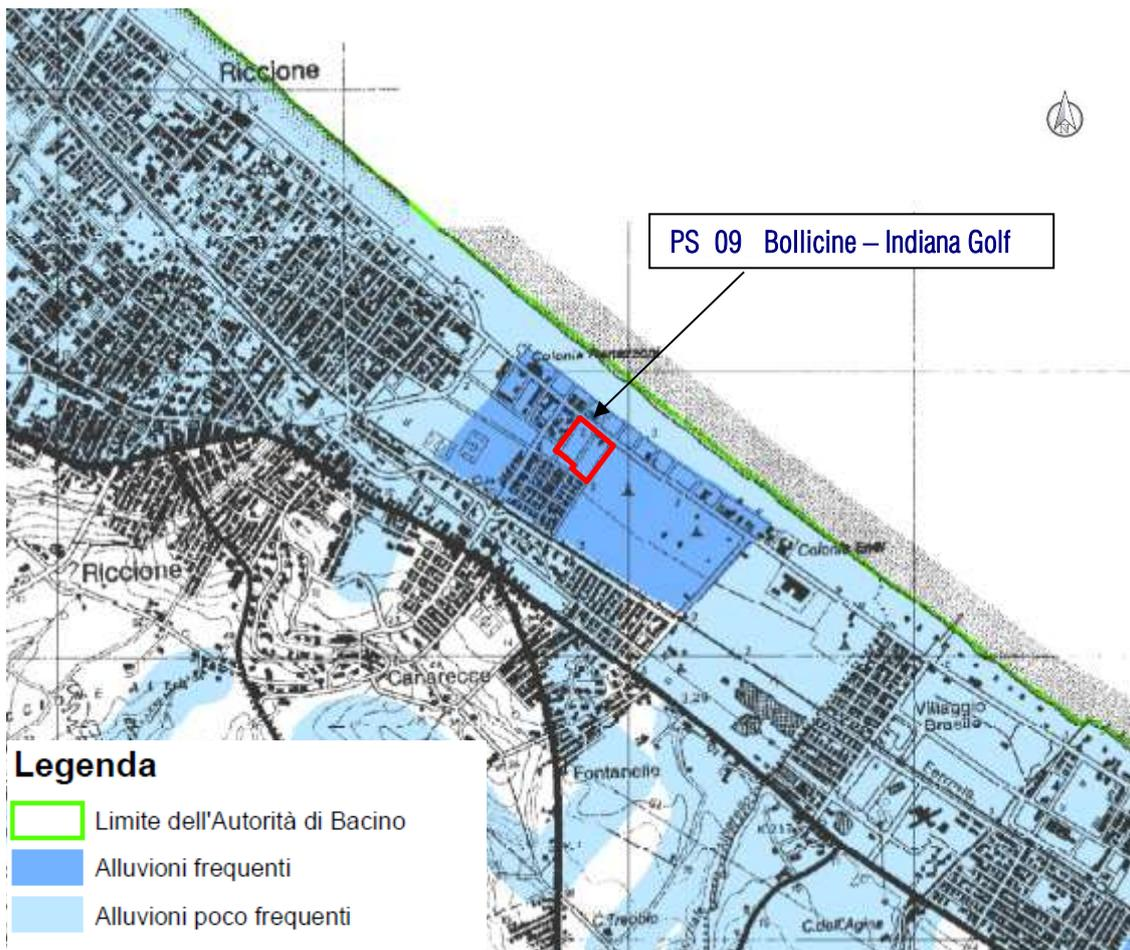
Fig. 4.2.2.a- Stralcio tavola 5.3 del Progetto di Variante 2016 del PAI – Mappa della pericolosità per il reticolo secondario di pianura
