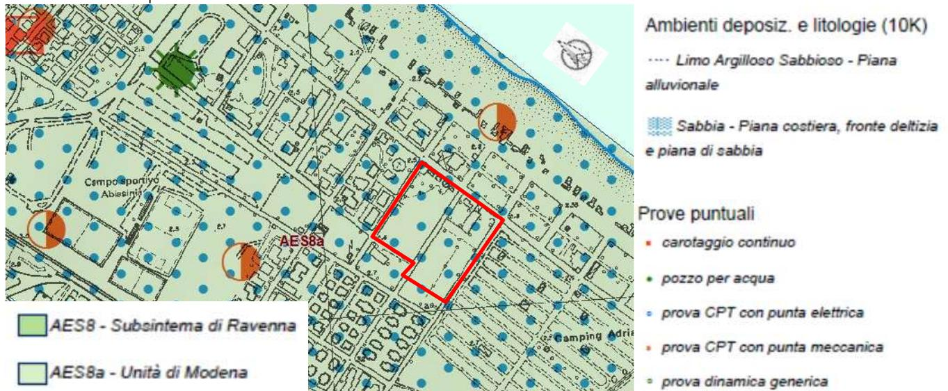
Fig. 2.1.1.a – estratto della carta geologica regionale dal sito dell'ufficio geologico regionale con indicate le prove puntuali realizzate nel tempo. Il "sole" verde è la terebrazione del 1985 descritta nel testo
